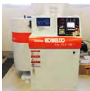
熱間等方加压装置 (等方的な圧縮加压と加熱処理)
