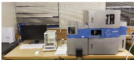
金属材料に含まれる炭素と硫黄の成分量を定量分析する炭素硫黄分析装置
