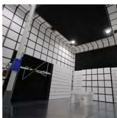
EMC試験を行う電波暗室
