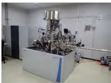
極表面複合分析装置 (極表面の原子の種類や数、 化学結合状態の分析)
