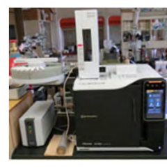
有機物質やガスの定性分析、定量分析ができるガスクロマトグラフ
