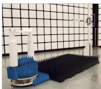
電波暗室、電磁波評価システム (電磁波ノイズ試験、アンテナ特性評価)
