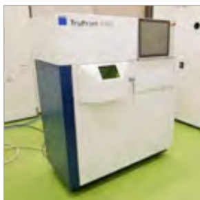
金属積層造形装置 (パウダーベッド方式)
