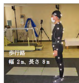
人体動作解析装置、生体安全評価装置 (動作計測や関節角度計測)
