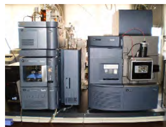
液体クロマトグラフ 飛行時間型質量分析計 (食品機能性成分の定量・定性分析)
