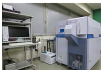
メッキ、アルマイト皮膜等を分析するグロー放電発光分光分析装置
