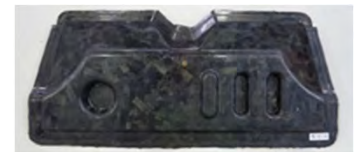
ファイアウォール部材（エンジンルームと運転席の仕切りパネル）
