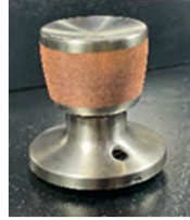
ブルーレーザ肉盛装置によるドアノブへの銅コーティング
