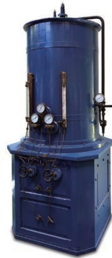
図 13 リンデ式空気液化分留器 [24]
