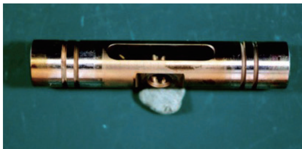
市販作動油により生じた油圧ポンプ試験機のサーボバルブ表面のラッカー皮膜（茶色部分）（著者らによる）
