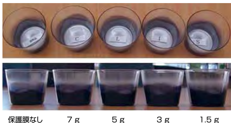
図 13 ユーザー評価用おちょこサンプルの外観 図中の数字は樹脂 30 g に対する粘土の添加重量。
