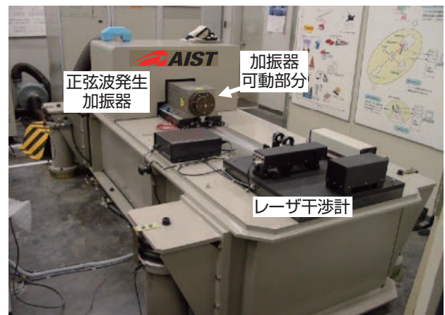
図13 開発した下限振動数が0.1 Hzの振動計校正装置
