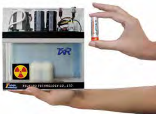
図18 手のひらサイズの乾電池駆動小型X線検査装置
