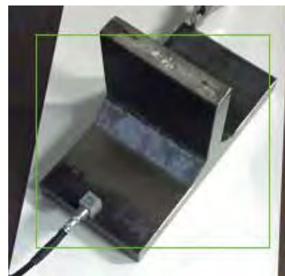
図6 T字溶接継手 (溶接コーナー部に欠陥)
