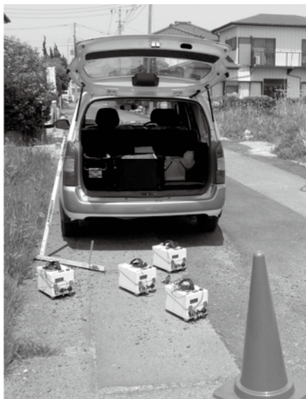
図2 半径 0.6 m の極小アレイ（図1（b））による観測風景
