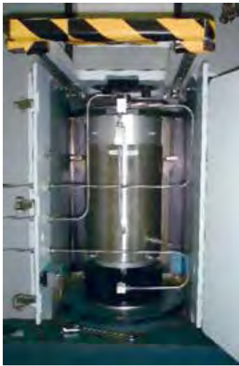
図8 材料試験機の試験片を取り付ける部分に設置する压力容器 岩石試料は压力容器の中で圧力（封圧）を加えて地下にあるのと同じ環境下で試験を行う。
