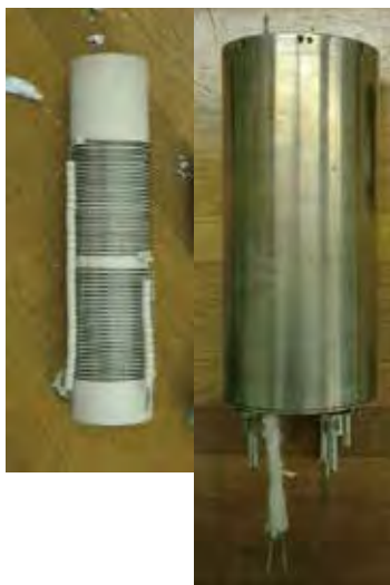
図9 独自開発したヒーター（電気炉） 高压下で実際の地下環境よりも高い温度を実現する。（左）ヒーター本体。セラミックスのチューブに電熱線をコイル状に巻き付けた。二つの部分からなる。（右）ヒーターの外観。
