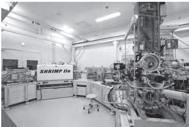
図7 高感度高分解能年代測定装置 SHRIMP ® (Sensitive High Resolution Ion Micro Probe)、Australian Scientific Instruments 社製
