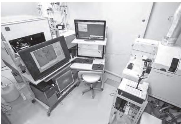
図5 LA-ICPMS（レーザーアブレーション誘導結合プラズマ質量分析計）、レーザー光源：サイバーレーザー社製、ICPMS：アジレント・テクノロジー社製、その他の部分はインハウスで組み立て。
