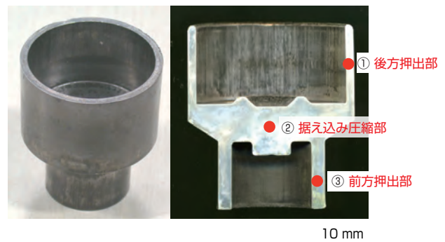
図7 試作鍛造品の例（素材：AZ91 マグネシウム合金連続鍛造材）
