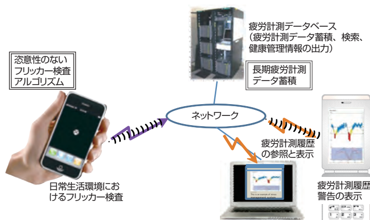
図 7 日常生活環境に利用可能な精神的疲労計測・管理システムのプロトタイプ
