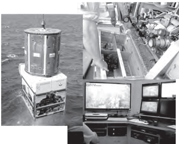
図7 GH12航海で使用した「白嶺」に搭載されている遠隔操作無人探査機 (ROV) システム
