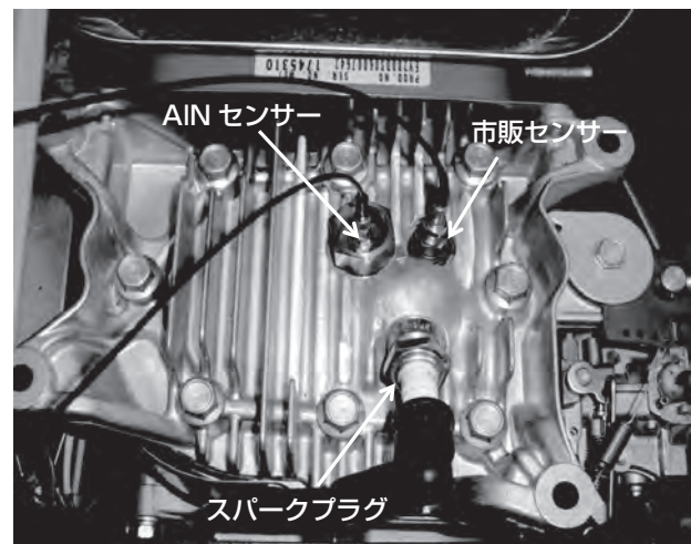
図14 センサーを取付けた4サイクルエンジンの外観
