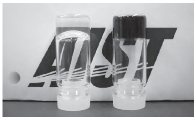
図4 倒立サンプル瓶中のヒドロゲルの写真(1 wt%濃度) 左:純水ゲル、右:単層カーボンナノチューブを含有したゲル(文献5より転載)
