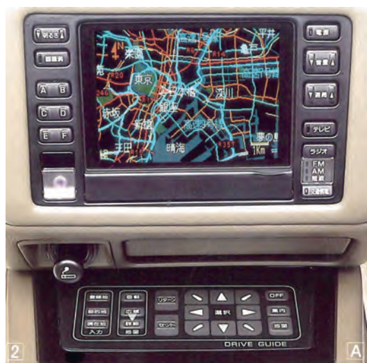
図2 カーナビゲーションシステム (1989年日産シーマのカタログより、日産自動車(株)提供)
