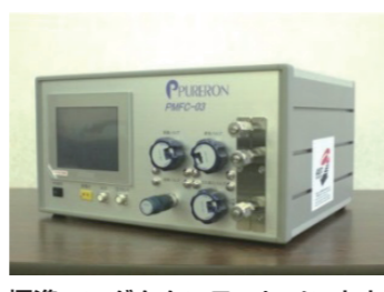
標準コンダクタンスエレメントを 組み込んだガス導入器 「分子フローコントローラー」
