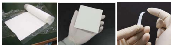
LiTAP (Li-Ti-Al-P₂O₅)セラミックシート 従来のリチウムイオン電解質シート材料(ガラス電解質)の約10倍のイオン伝導率@室温、且つ焼結性の高いシート部材
