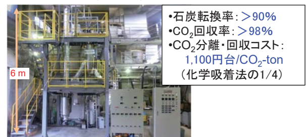
図2. 100 kWの三塔式循環流動床試験装置
