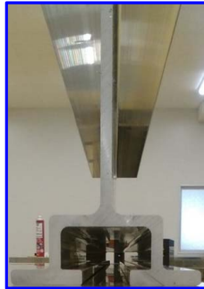
図 作製中の簡易モックアップ構体断面図 部材製造、接合、表面処理等、構体製造のための基礎技術を確立
