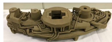
砂型3D造形技術により作成された 航空機用ギヤボックス中子
