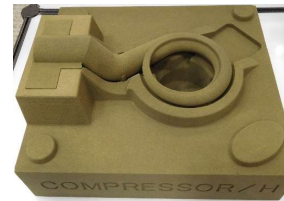
高速・大型積層造形装置と造形例 (ターボチャージャー中子： 12時間で650個を造形可能)
