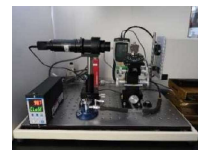
パルス試験機: 薄膜の物性を測定する装置
