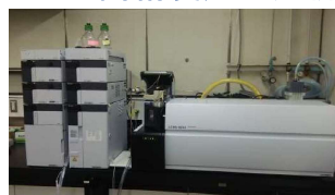
LCタンデム質量分析装置 (LC-MS/MS)
