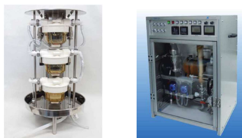
河川水Cs分析用前処理装置 (2012-2016)
