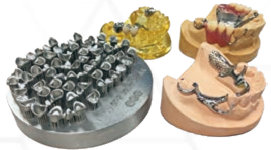
コバルトクロム合金粉末で作製した人工歯
