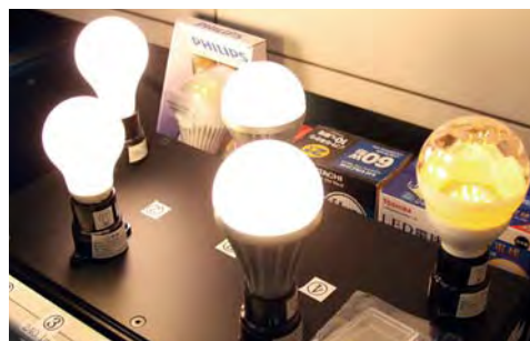
訪問者に電球、電球型蛍光灯とLED電球を比較点灯して見せるための点灯盤。手前右のLED照明はいわゆる粗悪品で暗さや色の悪さが目立つ。ユーザーには勿論歓迎されないが、訪問者へのデモンストレーションには最適で大活躍!
