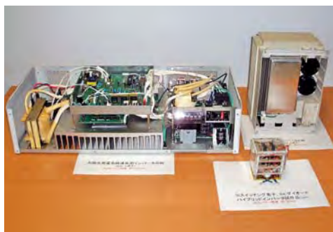
小型化を実現したシリコン(Si)MOSFETと炭化ケイ素(SiC)SBDによるハイブリッドインバータ(手前)、従来品に比べ出力パワー密度が約1桁向上した。奥の2台は従来型シリコン(Si)インバータ
