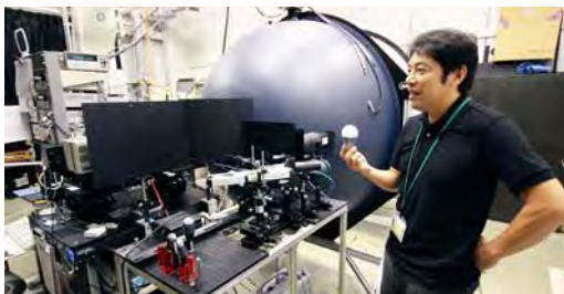
写真中央の積分球は内径1.65 mの大型装置。光取り出し口からの光を分光器で測定する
