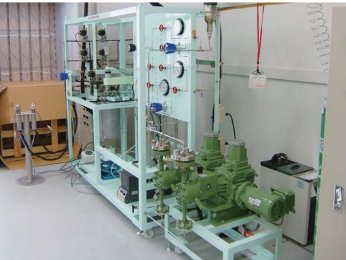
(左) 小型の実験装置 マイクロミキサーで塗料とCO 2 を迅速に混合させることができる
