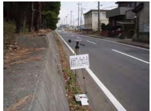
敷地境界地点での騒音測定 (つくばセンター)
