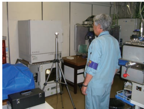
石綿作業環境測定士による気中分析
