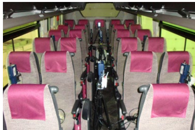
観光バス車内での計測の様子 -通路および各座席にCO 2 計とパーティクルカウンターを設置してCO 2 および粒子の濃度を計測-
