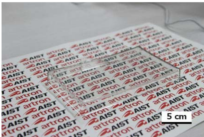
世界最高レベルの広い角度範囲で低反射特性を備えるパネル
