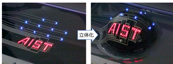
今回開発した技術によるLEDパネルの立体成形 [左：成形前、右：成形後（直径10 cmの半球状）]
