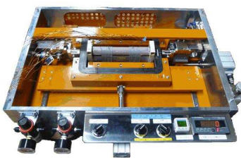
応力負荷型単板磁気試験器 【高精度磁気特性測定】
