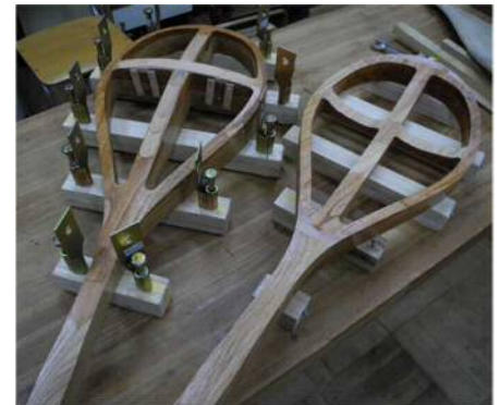
図4 収縮を妨げない開放型成形治具
