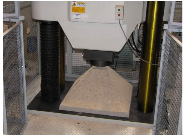
(d) オートグラフでの製品強度試験
