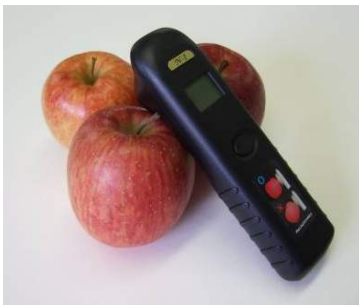
図1 商品化した携帯型糖度計。光源に発光ダイオードを使用し、重量200g（電池重量含む）と世界最軽量を実現した。
