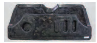
ファイアウォール部材（エンジンルームと運転席の仕切りパネル）
