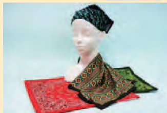
エレクトロスピンニングによる防虫ナノファイバーシート
