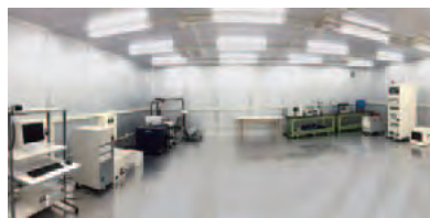
小型自動車が入室できる電磁環境負荷試験室
