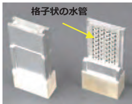
金型の内部水管化による製品の高精度化（金属）
