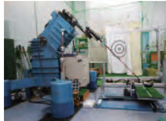
スポーツ用具の打撃試験ができるスポーツ用具評価システム
