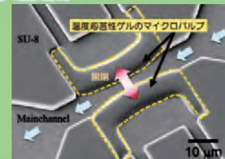
微細加工可能な温度応答性ゲルで製作したマイクロバルブ
