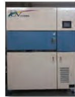
超促進耐候性試験機 SUV-W161 (岩崎電気株式会社)
