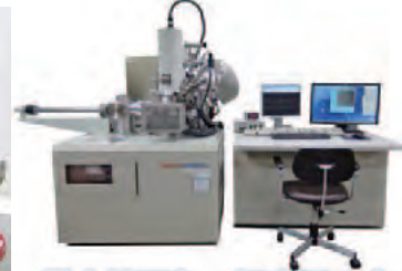
微小範囲かつ極表面の定性分析が可能なオージェ電子分光分析装置
