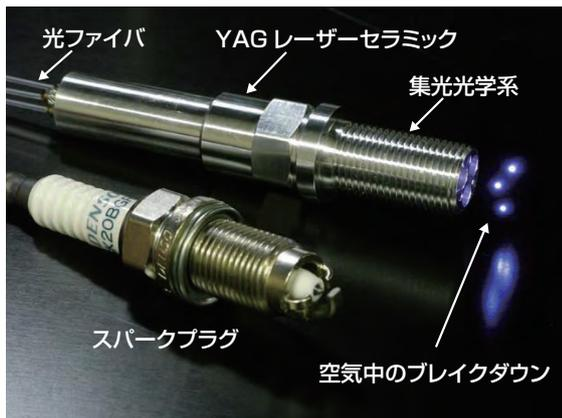
図7 マイクロチップレーザー<sup>[14]</sup>
