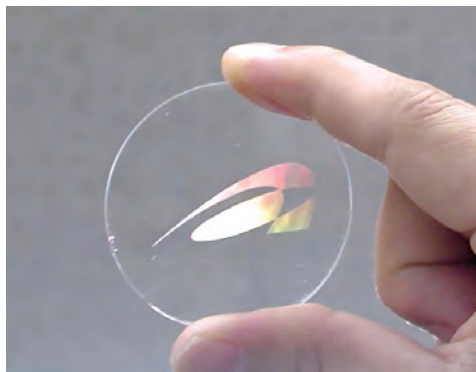
図12 石英ガラスへのLIBWE法大面積加工：レーザー走査照射型装置にて作製（左図の着色部は、透過型回折格子からの散乱光）。 [14]
