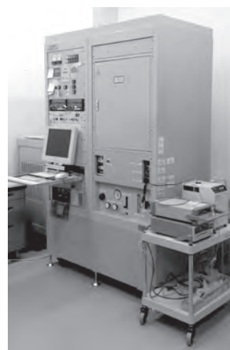
図7 熱拡散率の国家標準器
