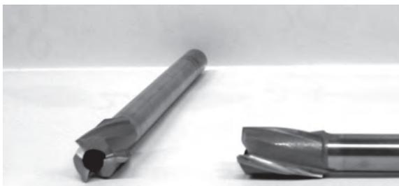
図7 試料くりぬき用コアドリル (内径 7 mm)
