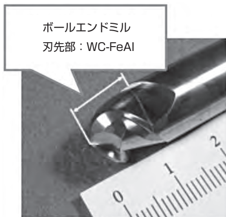
図5 WC-FeAl で試作したボールエンドミルの外観
