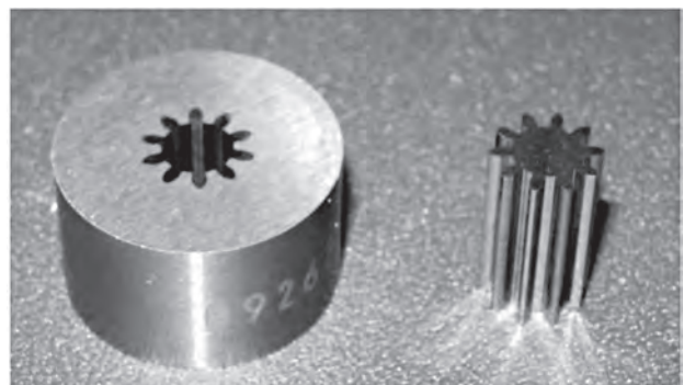
図3 WC-FeAl 超硬合金製金型の外観
