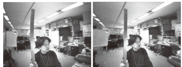
図5 レンズ歪み補正 人物が手に持っているのは直線定規である。左の補正前の画像では弓形に歪んでいることがわかる。右は補正処理を行ったものである。天井のライン等も歪みが補正されていることがわかる。
