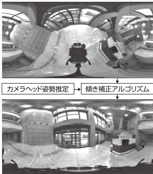
図6 カメラヘッドの姿勢推定および傾き補正 全方向画像中の鉛直及び水平エッジからカメラヘッド自らの姿勢を推定する。上段は補正前の画像である。全方向画像なので傾きの影響がサインカーブ状に現れる。中央付近に写る黒い物体は電動車いす本体である。下段は推定したパラメーターを用いて補正した画像で、横方向が水平、縦方向が鉛直に対応するよう補正されている。
