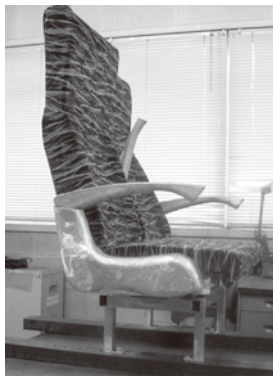
図12 難燃性マグネシウム合金（AMX602）の鉄道車両用腰掛
