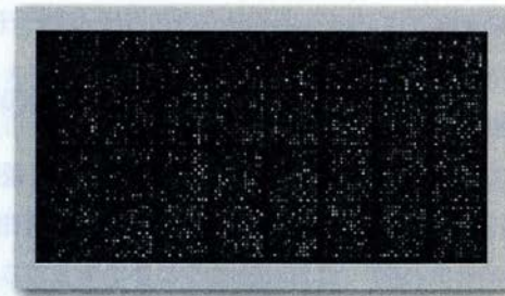
(b) Stanford型のDNAチップ (～数千プローブ/cm 2 )
