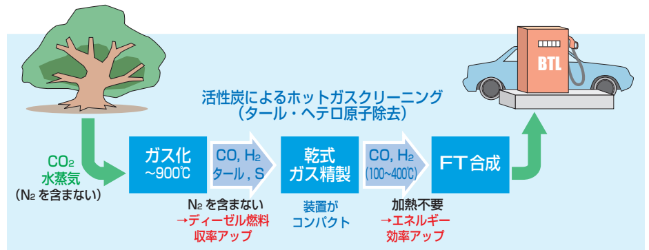
図2 木質バイオマスの高効率BTL-FTディーゼル製造トータルシステム
