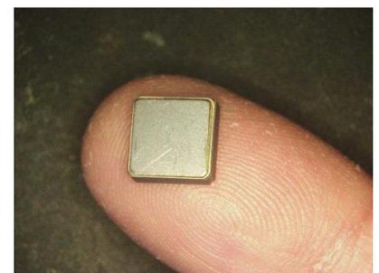
図2 加速度センサ外観
