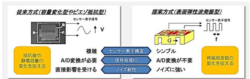
図1 新方式加速度センサの特徴
