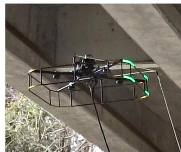
橋梁点検用飛行ロボット
