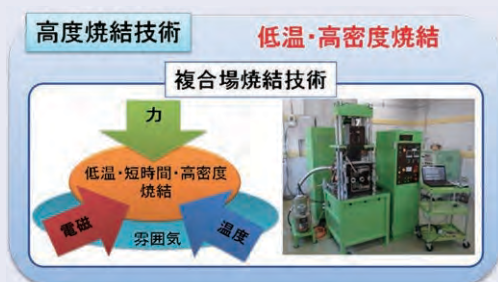
粉末の特性を低下させずに高密度に焼結する技術の概念
