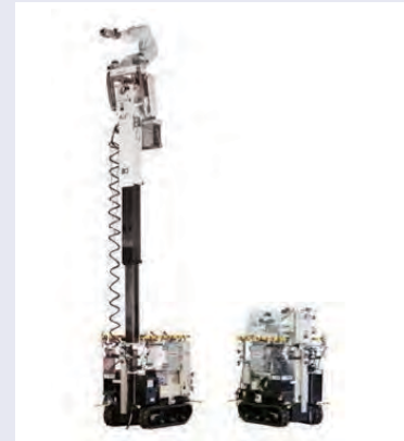
高所調査用ロボット (左：高所調査姿勢、右：移動姿勢)
