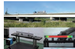
モアレ計測による橋梁モニタリング実験
