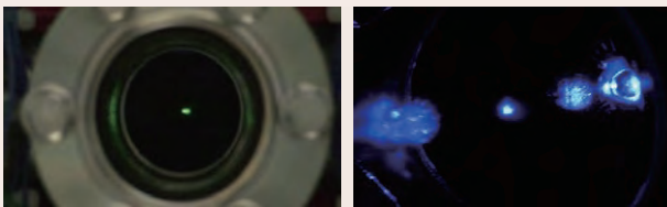
レーザー冷却された極低温イッテルビウム原子集団(左)と極低温ストロンチウム原子集団(右)
