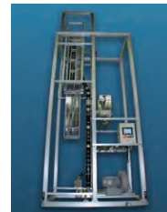
廃製品データベースを利用した世界初のタンタルコンデンサリサイクル装置
