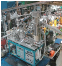
超伝導蛍光収量X線吸収微細構造分析装置
