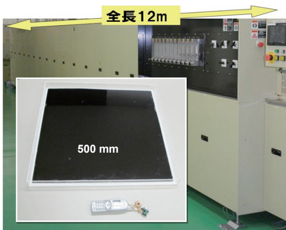
低コスト大量生産 (0.6kg/日) が可能なパイロットプラントと 500mm x 500 mm 大面積基板上の CNT
