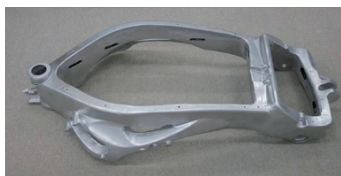
2 輪車フレーム部材 一体成形・60% 軽量化
