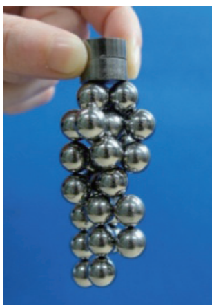
Dyを含まない高性能焼結磁石(Sm-Fe-N系) 磁石を2段重ねにしたものに、パチンコ球30個が着いている。
