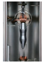
質量5kgの ^{28}\text{Si} 同位体濃縮結晶
