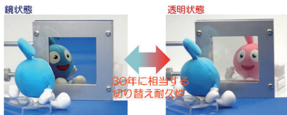
マグネシウム・イットリウム系合金を用いた、鏡状態と透明状態の切り替えに対する耐久性に優れた、ガスクロミック調光ミラー
