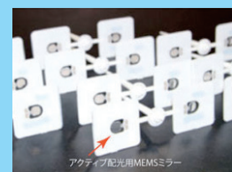
印刷と射出成形だけで作製した アクティブ配光用 MEMS ミラー
