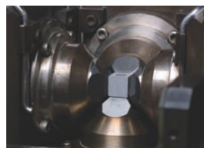
新物質合成に威力を発揮する超高压合成装置と新たに開発された高温超伝導体の結晶構造
