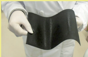
チタン並の熱伝導率をもつ 単層カーボンナノチューブ複合材料
