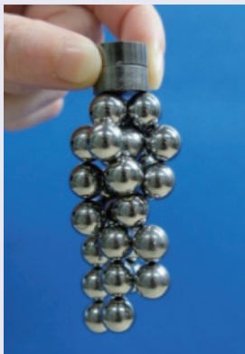
Dy を含まない高性能焼結磁石(Sm-Fe-N 系) 磁石を二段重ねにしたものに、パチンコ玉 30 個が着いている
