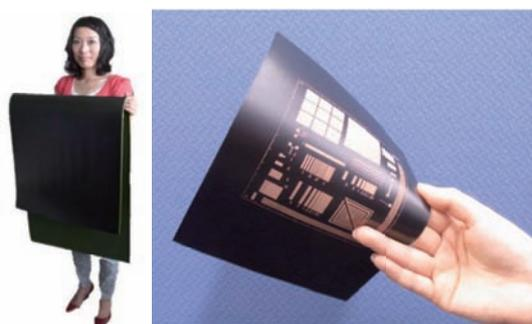
耐熱フィルムロール品と電子回路印刷例
