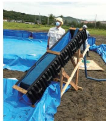
開発した吸着材を用いたセシウム除染水路
