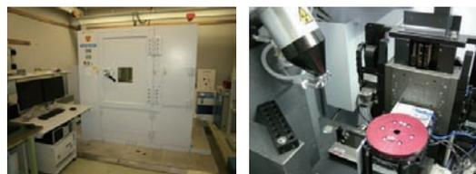
試作したトレーサブル X 線 CT 装置の外観（左）と内部（右）
