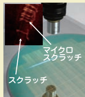
半導体ウエハ表面層の マイクロクラック検出
