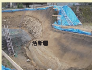
地震断層のトレンチ調査
