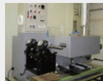
電極製造設備
