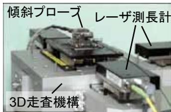
開発中のプローブ傾斜機構付き走査システム
