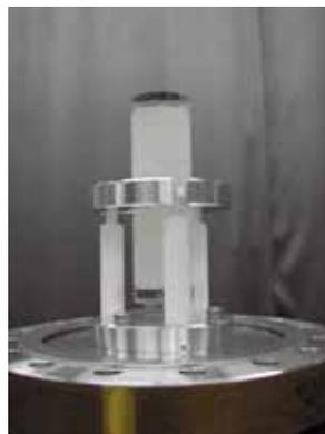
時計遷移レーザー安定化用高フィネス共振器
