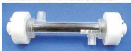
炭化水素混合蒸気中からの脱水プロセスなど、化学プロセスの省エネルギー化を実現するために必要な膜分離、吸着分離等の技術を開発します。具体的には、膜分離性能の向上、膜モジュール技術の開発、膜分離プロセスの設計を進めることにより、蒸留等を用いた現行プロセスの消費エネルギーを50%削減できる膜分離技術を開発します。
