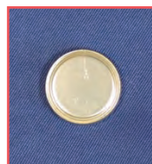
性能評価用コイン電池、円筒型電池
