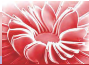
スーパーグロース法を用いた高純度単層CNT
