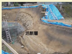
地震断層のトレンチ調査
